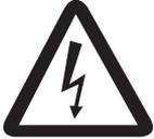
**Non aprire il coperchio a meno che non si abbia una conoscenza approfondita dei circuiti elettrici e del manuale di assistenza.**
